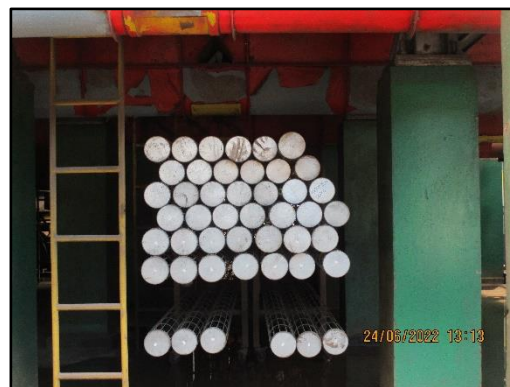
ภาพที่ 2.5 ถุงกรอง (Bag Filter) และอะไหล่สำรองของหน่วยถุงกรอง (Bag House)
