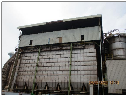
ภาพที่ 2.1 ระบบดักฝุ่นแบบถุงกรอง (Bag Filter) ภายในหน่วยถุงกรอง (Bag House)
